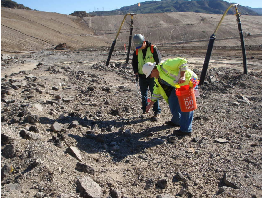
Foto 4.1 Estudio de Campo Típico para Determinar las Ubicaciones de las Tomas de Muestra de la Cámara de Flujo.
