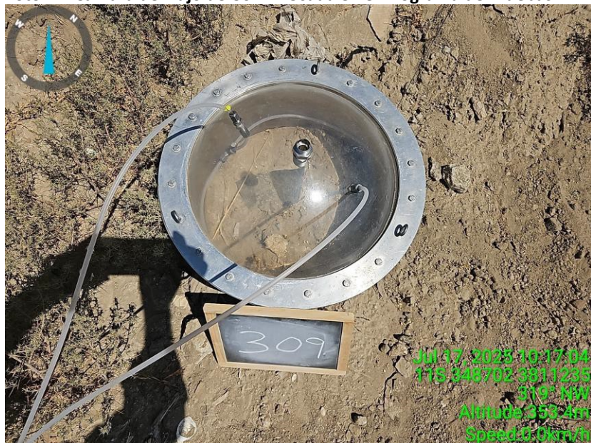
Foto 1.1 Cámara de Flujo de USEPA Usada en el Programa de Pruebas.
