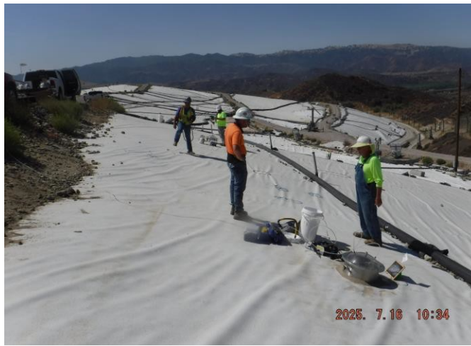
Foto 1.2 Cámara de Flujo en la Parte que Cubre la Membrana del Vertedero.
